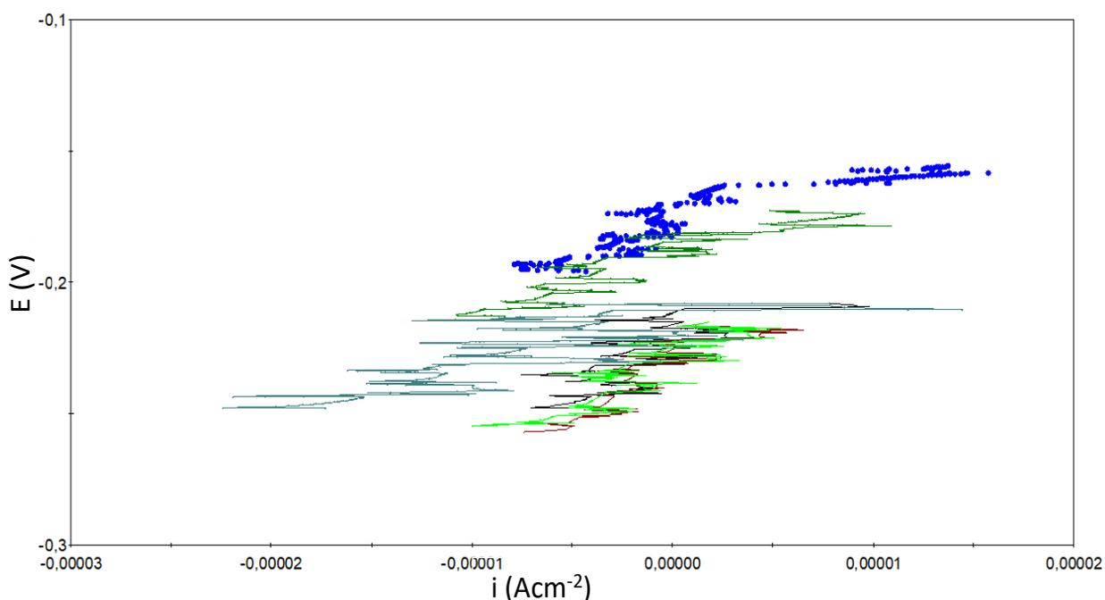
Figure 3. Polarization curves of copper in 3% NaCl: ---- 3% NaCl; ---- 3% NaCl+0,01612  $\text{gdm}^{-3}$ ; ---- 3% NaCl+0,03221  $\text{gdm}^{-3}$ ; ----3% NaCl+0,04828  $\text{gdm}^{-3}$ ; ---- 3% NaCl+0,06432  $\text{gdm}^{-3}$ ; ----3% NaCl+0,08033  $\text{gdm}^{-3}$
