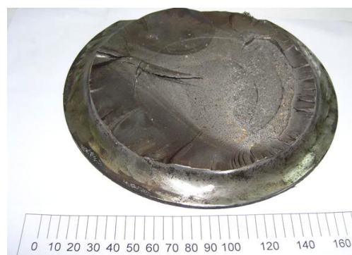
Slika 8. Izgled prelomne površine vagonске osovine [26]
