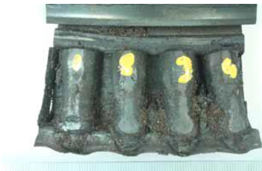
Slika 11. Pogled izbliza na plastično deformisane valjke ležaja [30]
