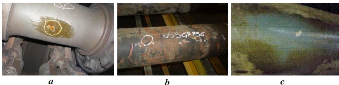
Slika 5. Primeri oštećenja osovina železničkih vozila tokom eksploatacije. a: odvajanje farbe; b: rupičasta (pitting) korozija; c: oštećenje od udara balasta [1]
