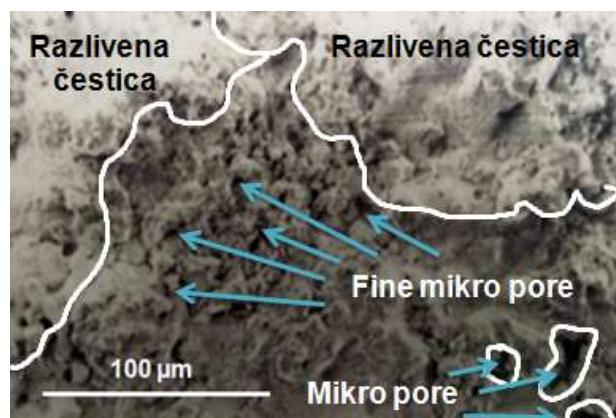
Slika 7. (SEM) Morfologija površine  $\text{Al}_2\text{O}_3$ 28tež.%MgO prevlake
