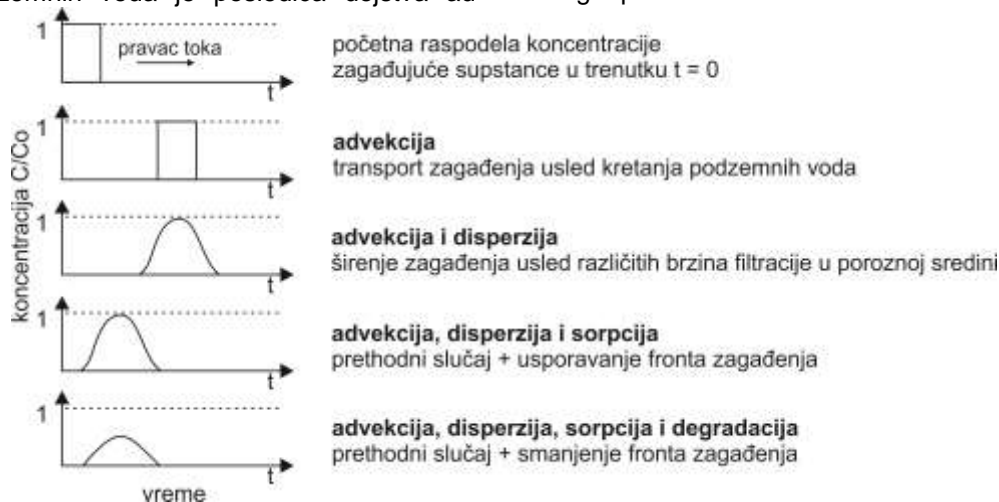
Slika 1. Uticaj advekcije, disperzije, sorpcije i degradacije na transport zagađenja u poroznoj sredini [19]
