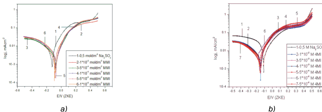
Slika 3. Polarizacione krive bakra u kiselom 0,5 \text{ mol dm}^{-3} rastvoru \text{Na}_2\text{SO}_4 u prisustvu različitih koncentracija a) 2-merkapt-1-metilimidazola; b) 4(5)-metilimidazola
