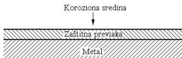
Slika 1 - Šematski prikaz privremene zaštite kontaktnim postupkom
