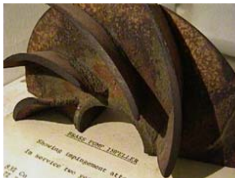
Slika 2.5. - Decinkacija mesingane turbine pumpe za vodu
