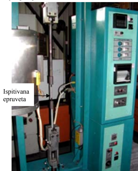
Slika 2 - Izgled uređaja i epruvete kod ispitivanja vodonične krstosti
