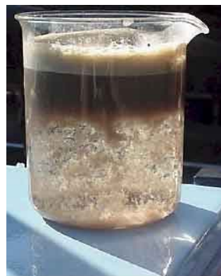
Slika 16 - Elektrokoagulacija u procesu : a) uklanjanja teških metala (hroma); b) uklanjanja masti i ulja
