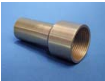
Slika 5 - Površina magnezijuma nakon tretmana konverzionim hromatnim postupkom
