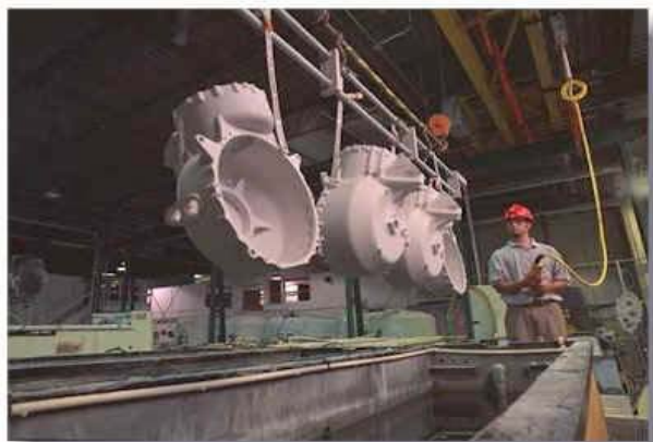
Slika 12 - Prevlaka na proizvodima od magnezijuma dobijena Tagnite tretmanom
