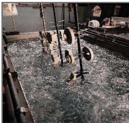
Slika 4 - Proces nanošenja prevlake na magnezijumu, prikaz jednog od kupatila
