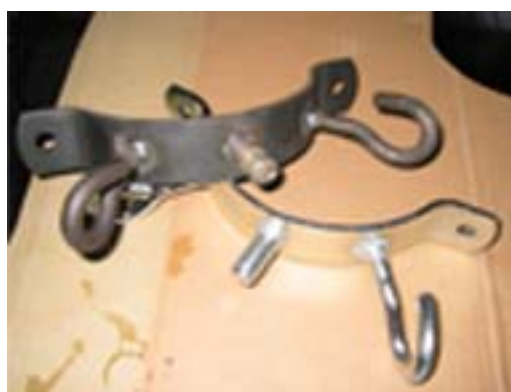
Slika 1 - Uporedni prikaz izgleda neobrađenog i obrađenog predmeta od čelika negarantovanog sastava
