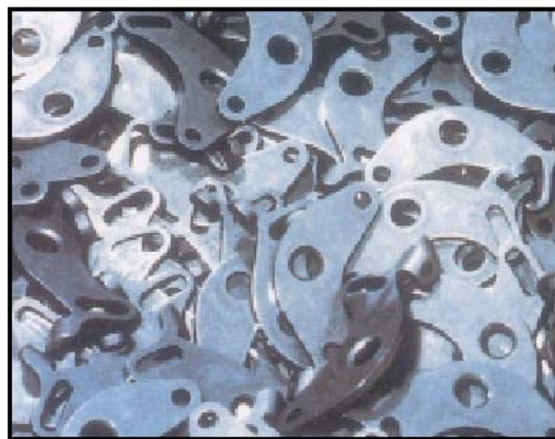
Slika 9 - Izgled površine čelika nakon nanošenja cink-fosfatne prevlake modifikovane kalcijumom
