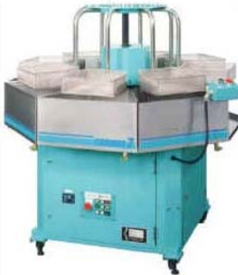
Slika 5 - Aparatura za nanošenje fosfatne prevlake na povišenim temperaturama: a) redosled operacija, b) izgled aparature
