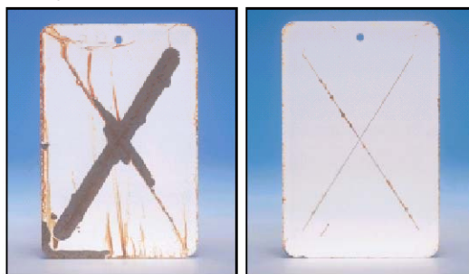
Slika 12 - Izgled pločica nakon testiranja u slanoj komori
