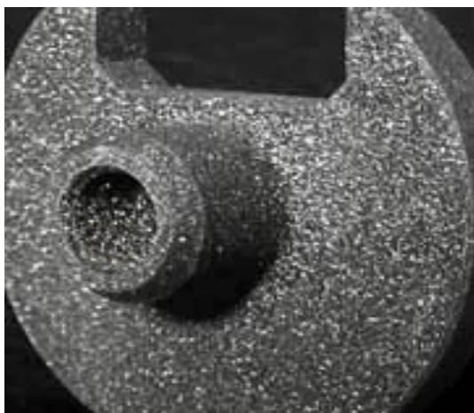
Slika 4 - Izgled gvožđe-fosfatne prevlake
