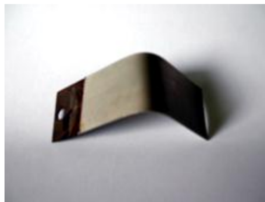
Slika 3 - Izgled epruvete nakon provedenog testa na savijanje pod uglom 90^{\circ} (bend test)
