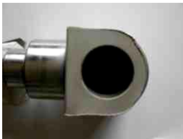
Slika 5 - Izgled originalnog dela komponente noge stajnog trapa (tee bolt fitting)
