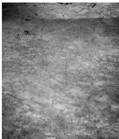
Slika 6 - Detalj mikrostrukture sinterovanog uzorka CuAg4at% nakon hladnog valjanja stepenom deformacije \epsilon=50\% , (300X).
