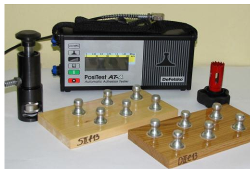
Slika 2. Merenje adhezije metodom pečatnika na uzorcima hrasta i smrče
