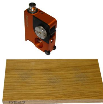
Slika 1. Merenje adhezije metodom rešetke na uzorku hrasta
