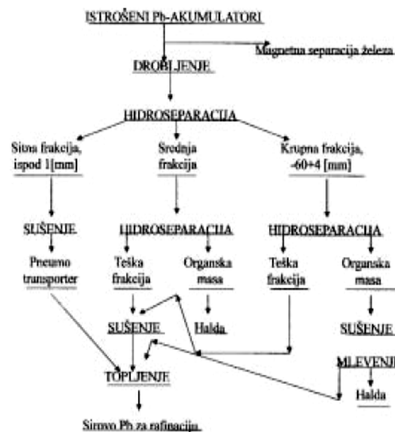
Slika 13 - Osnovna tehnološka šema prerade akumulatora hidroseparacijom. Slične postupke hidroseparacije imaju sledeće firme: BBU – Austrija, "Tonoli" – Milano, kombinat – Trepča – Zvečan, "Humboldt" – Nemačka, "Pena-raja" – Francuska, "Gincvemet" – Rusija
