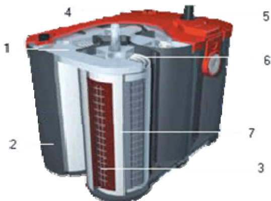
Slika 3 - Presek spiralnog olovnog akumulatora (Optima): 1. Kompaktni, liveni priključci, 2. Sa poklopcem uliveno plastično kućište koje štiti od hemijskih i fizičkih oštećenja, 3. Olovne ploče velike čistoće, 4. Sigurnosna slavina protiv požara, 5. Polovi zaštićeni protiv korozije, 6. Kompaktno umotane spiralne ćelije, 7. Specijalna mikroporozna staklena vuna koja u celosti upija elektrolit između spiralnih ploča.
