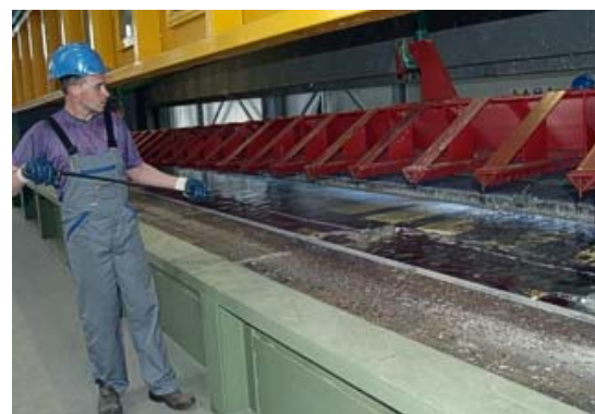
Potapanje očišćenih i osušenih elemenata u rastopljeni cink
