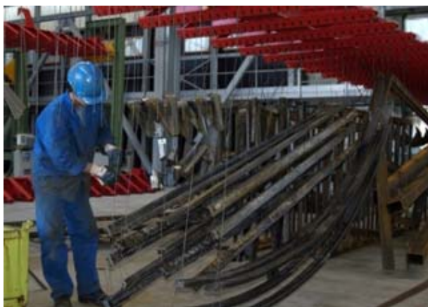
Kačenje elemenata na posebne grede
