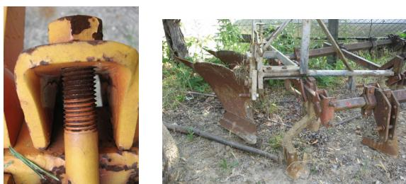
Slika 5 – Primeri atmosferske korozije na elementima i delovima pojedinih sredstava mehanizacije.
