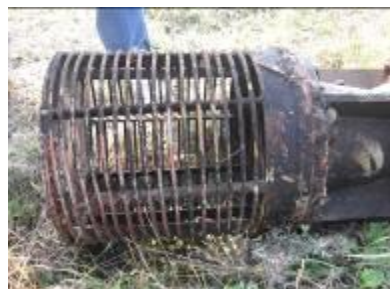
Slika 4 - Korpa pumpe izvađena iz bunara na izvorištu Ključ
