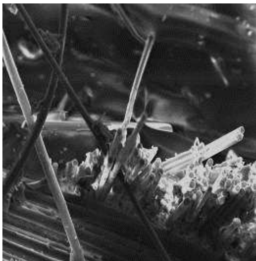
Slika 5 - Različito vremensko pucanje vlakana prikazano na SEM-u: a) orijentacija vlakana 0/90^\circ , b) orijentacija vlakana \pm 45^\circ )
