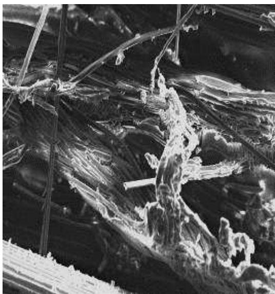
Slika 9 - Nedostatak matrice: a) orijentacija vlakana 0/90^\circ , b) orijentacija vlakana \pm 45^\circ
