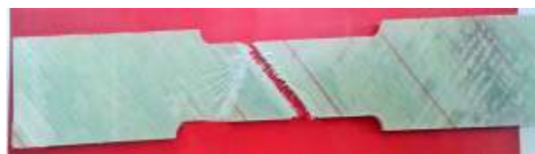
Slika 4 - Izgled prelomljenih uzoraka (Z-SE-1 ±45°)
