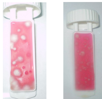
Slika 5 - Etalon Roze – bengalskog agra za određivanje plesni u emulziji i fotografija pločica sa hranjivom podlogom koje su tretirane sa emulzijama koje su korišćene šest meseci.
