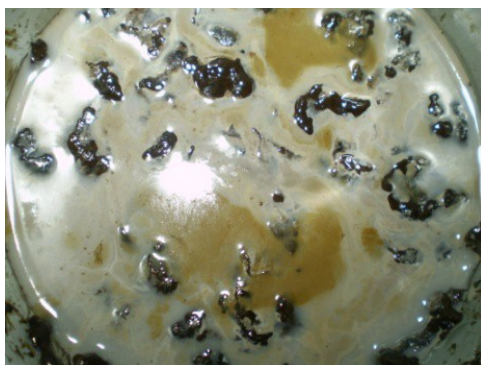
Slika 1 - Fotografija nakupine biofilma koji je sastrugan sa povratne cevi za transport emulzije kod sistema 1.
