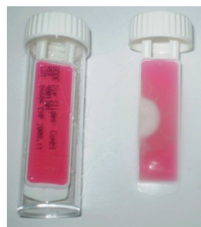
Slika 4 - Etalon Roze – bengalskog agra za određivanje plesni u emulziji i fotografija nove pločice sa hranjivom podlogom i pločice koja je tretirana sa emulzijom koja je korišćena tri meseca.
