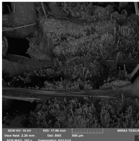
Slika 10 - Prsline nastale usled gubitka matrice, prikazane na SEM-u
