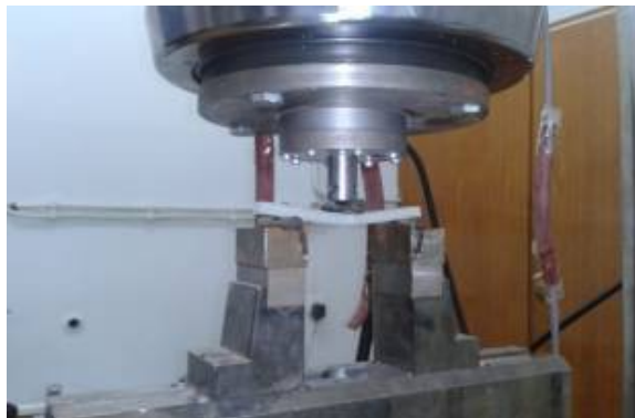
Slika 3 - Odvijanje eksperimenta na elektro-mehaničkoj kidalici INSTRON 1332
