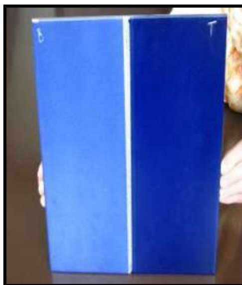
Slika 9 - Keramička pločica proizvedena uz korišćenje sintetizovanog plavog pigmenta kobalt-olivina u beloj (B), i transparentnoj glazuri (T)
