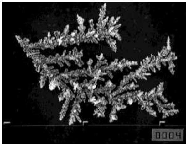
Slika 1 - Razvoj morfoloških oblika sa povećanjem prenapetosti: a) poliedri, 5 mV (uvećanje x200); b) "šuplji" kristali, 50 mV (uvećanje x 3500), c) dendriti, 100 mV (uvećanje x500), d) aglomerati dendrita, 250 mV (uvećanje x100)
