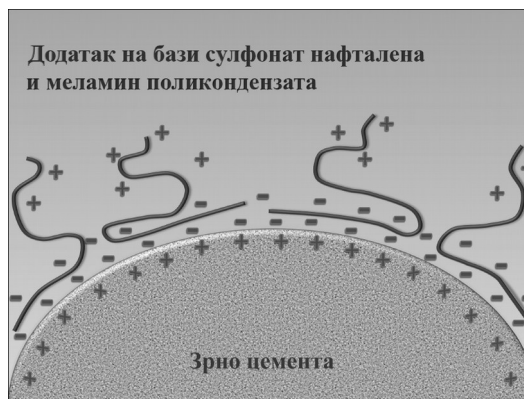
Слика 3 - Шематски приказ механизма дејства конвенционалних пластификатора и суперпластификатора
