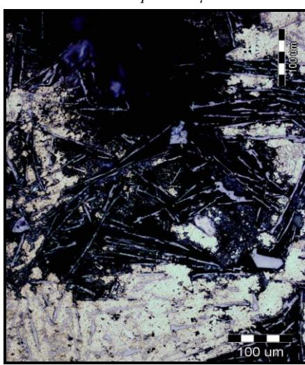
d) Presjek Al-Si uzorka: detalj iz (c), povećanje mikroskopa: 200x
