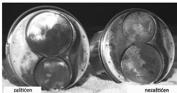
Slika 3 - Izgled zaštićenog (na slici lijevo) i nezaštićenog klipa nakon eksploatacije
