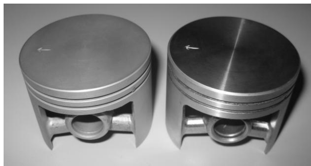
Slika 2 - Izgled kalajisanog (na slici lijevo) i nezaštićenog klipa
