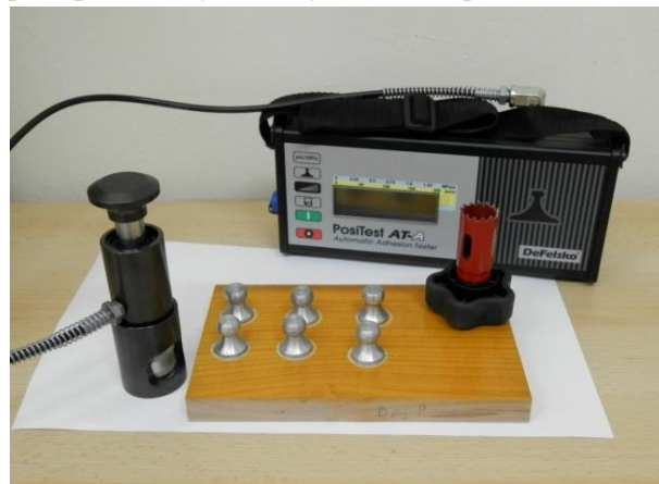
Slika 4 - Određivanje adhezije metodom pečatnika
