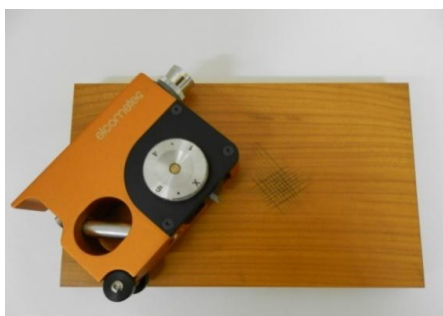
Slika 3 - Određivanje adhezije metodom rešetke
