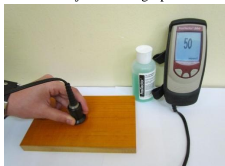
Slika 2 - Određivanje debljine suvog filma premaza
